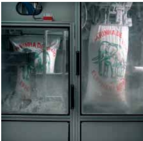
Geautomatiseerd afvullen van zakken in een afgesloten ruimte
