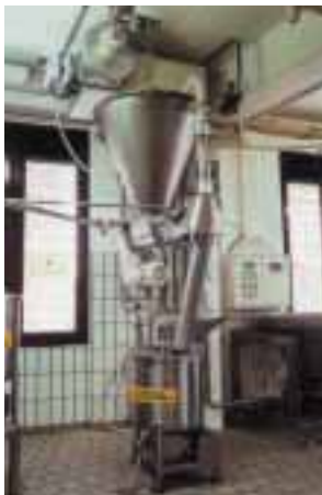
Doseerinstallatie om grondstoffen ook in vloeistofvorm toe te voegen aan de mengkuip
