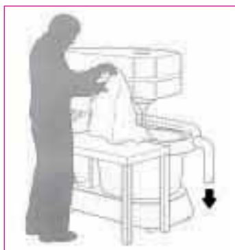
Ontwerp van ringafzuiging voor tonnen, zakken en kuipen
