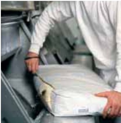
Stofarme werkwijze voor legen van zakken
