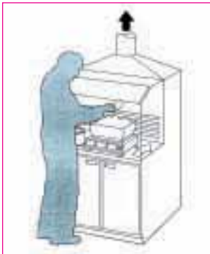
Voorbeeld van een weegcabine met afzuiging (voor het wegen van kleine hoeveelheden grondstof)
